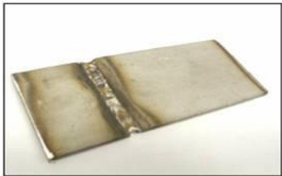
Vista frontal de una muestra soldada con MAGNA 39 sobre Ac. Inox 304, abertura de 2 mm
