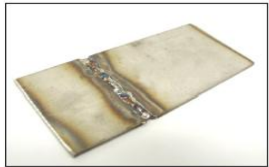
Cara posterior de la muestra soldada sobre Ac. Inox 304, abertura de 2 mm
