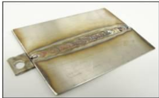
Cara posterior de la muestra soldada sobre Ac. Inox 316, abertura de 2.5 mm
