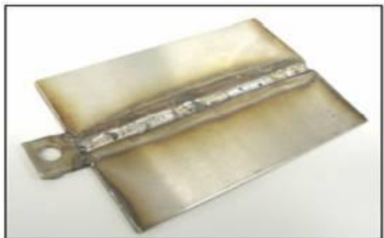
Vista frontal de una muestra soldada con MAGNA 39 sobre Ac. Inox 316, abertura de 2.5 mm
