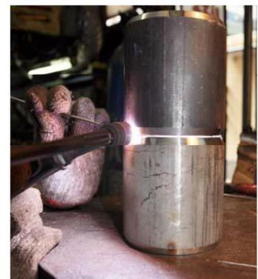
martensítica en los metales después de la soldadura de los dos metales base diferentes, sin protección un soldador puede unir acero al carbón con acero inoxidable o acero de baja aleación con acero inoxidable usando Magna 309.
