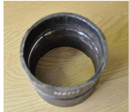
Magna 309 penetra la cañería y protege efectivamente de la oxidación al cordón de la soldadura posterior.
