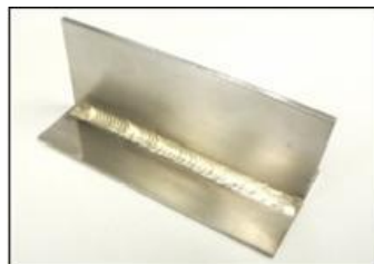
Vista frontal de una muestra soldada con Magna 28 sobre Acero Inoxidable
